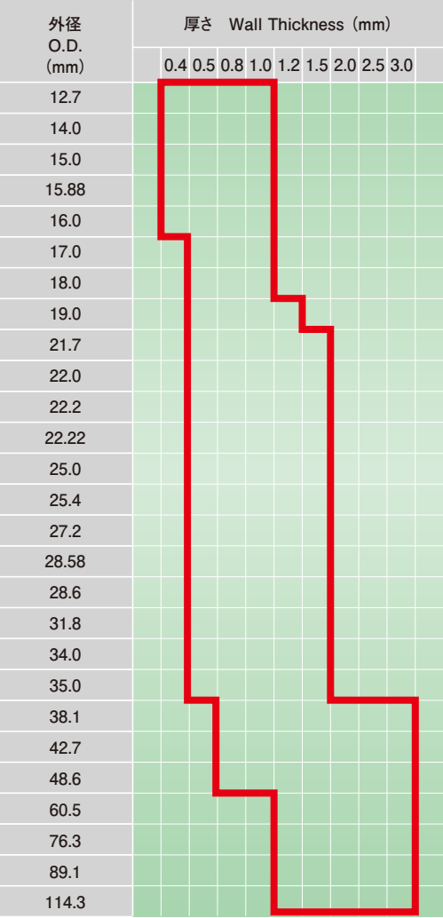
レーザー溶接管製造可能範囲 (尼崎工場) Size Availability of Laser welded pipe (Amagasaki Works)
