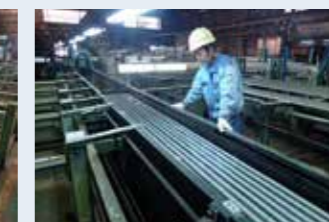
空気圧試験 Pneumatic Test
